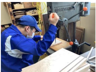
木工科：ボール盤による穴開け
