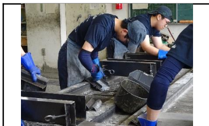
工業科：民地仕切り石（大）の型枠磨き
