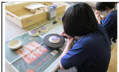
窯業科：撥水材塗り
