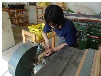
木工科：溝加工作業
