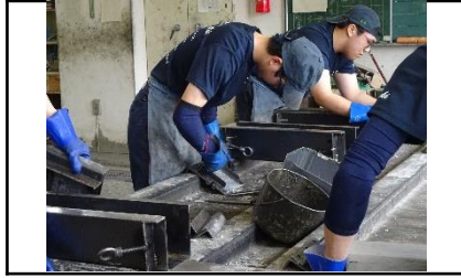
工業科：民地仕切り石（大）の型枠磨き
